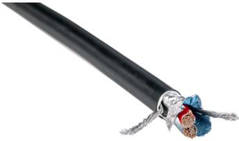
HELIAX® Stromkabel, weiß & rot mit Aluminiumschirm mit einer Anzahl von 2x6 mm<sup>2</sup> Adern, schwer entflammbar CPR Klasse B2ca s1, d2, a1 bewertet, 500 Meter
