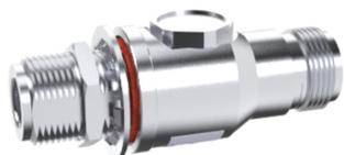
Parafoudre à tube de gaz (® 90 V), 45– 2170 MHz, avec types d'interface N Femelle Cloison et N Femelle
